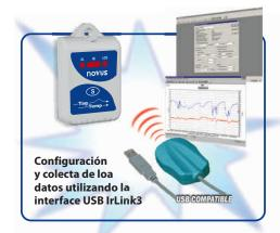
Interface USB IrLink3 permite la comunicación sin contacto físico entre el TagTemp y la computadora (en ambiente Windows®) a través del puerto USB. La comunicación infrarroja funciona en distancias de hasta 50 cm.
